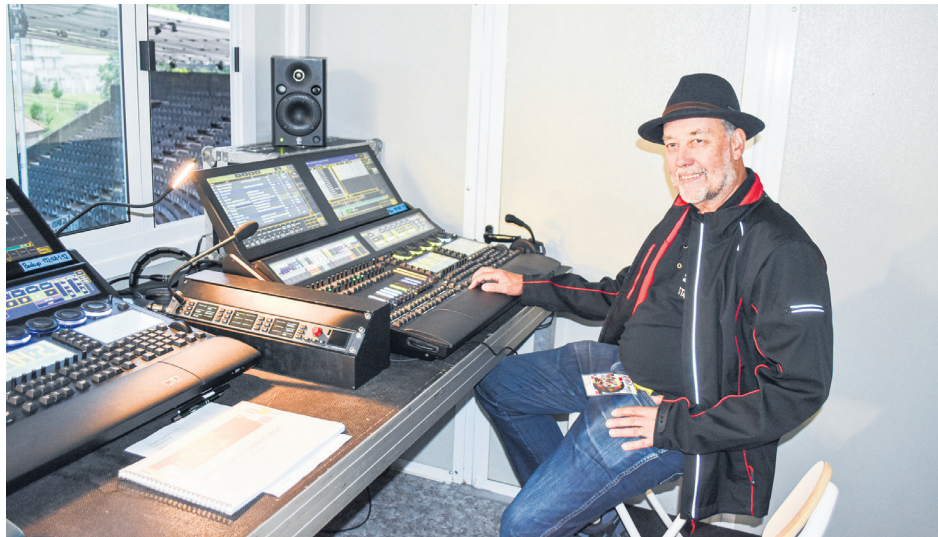
Von diesen Pulten aus steuern die Operateure das Licht. Hans Grätzer ist einer der Bediener. Fotos: reh.
